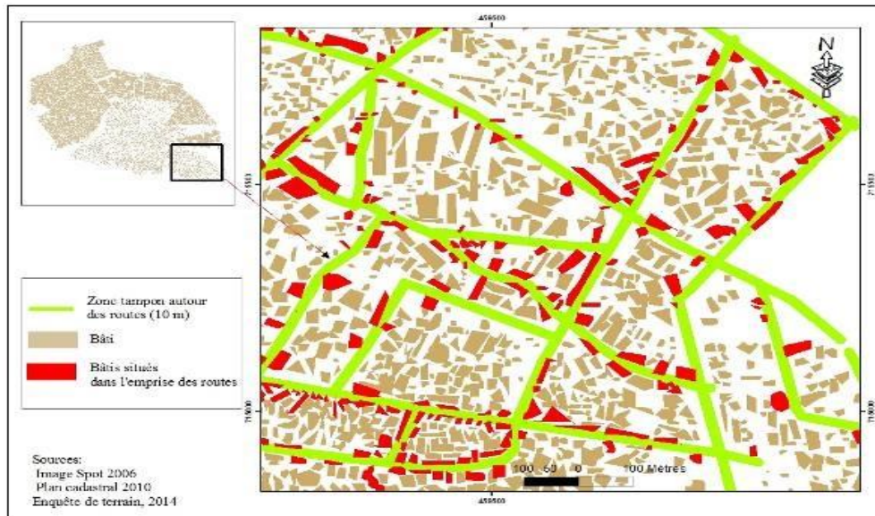
Figure 3 : Bâtiments situés dans l'emprise de la zone tampon
