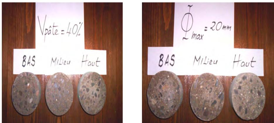
**Photo 6 et 7 :** Observation de la répartition des granulats dans les trois parties de l'éprouvette (BAP au volume de pâte  $V_{p\hat{a}te} = 40\%$  et BAP avec un diamètre maximal de granulats  $\Phi_{max} = 20\text{ mm}$ )
