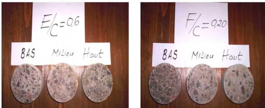
**Photos 4 et 5 :** Observation de la répartition des granulats dans les trois parties de l'éprouvette (BAP au rapport  $E/C = 0,6$  et BAP au rapport  $F/C = 0,2$ )
