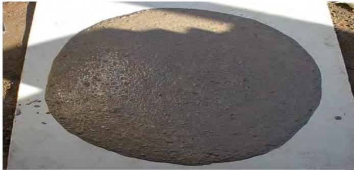
**Photo 1 : Essai d'étalement**
