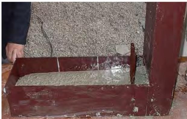
**Photo 2 :** Remplissage du béton à l'amont des armatures
