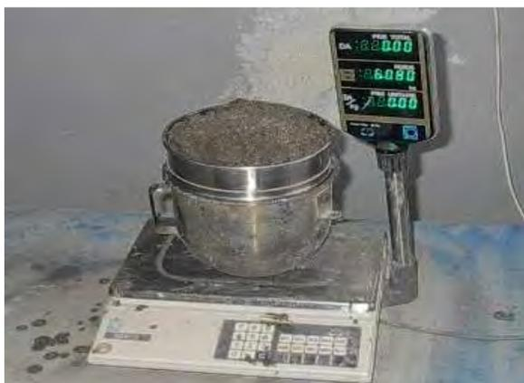
**Photo 3 :** Essai de stabilité au tamis
