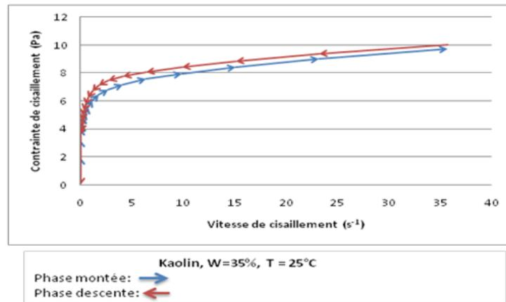
**Figure 1.b :** *Courbes d'écoulement pour le kaolin*
