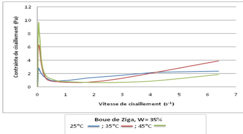
**Figure 4 :** *Contrainte minimale en fonction de la température*
