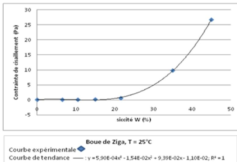
**Figure 2 :** *Contrainte seuil en fonction de la siccité*
