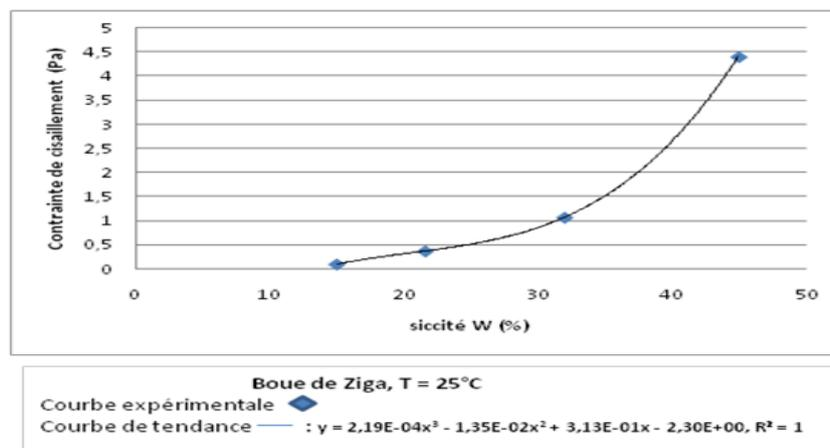
**Figure 8 :** *Contrainte minimale en fonction de la siccité*
