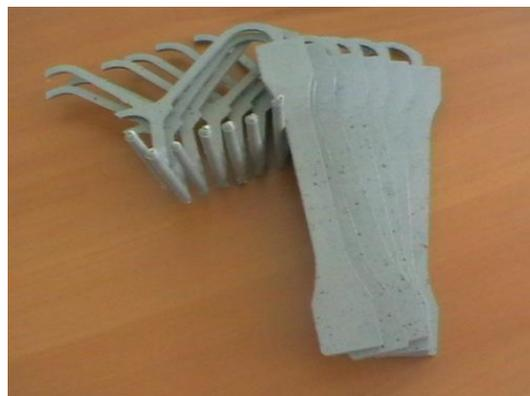
**Figure 11 :** Eprouvettes de traction injectées avec dispositif d'injection
