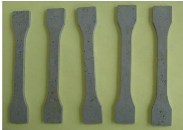
**Figure 15** : Epreuves de traction injectées
