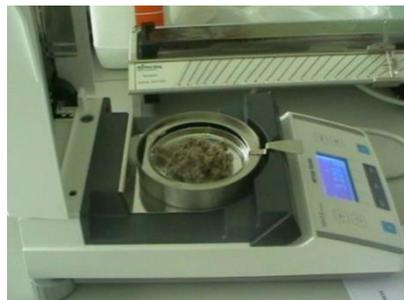
**Figure 5 : Balance d'humidité**
