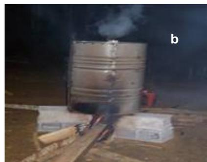
**Figure 4** : traitement thermique du substrat de culture : sacs couverts d'aluminium (a), apparition de la vapeur à la face supérieure du fût (b).
