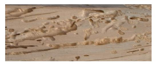
Figure 3. Damages of *H. bajulus* (L.).
