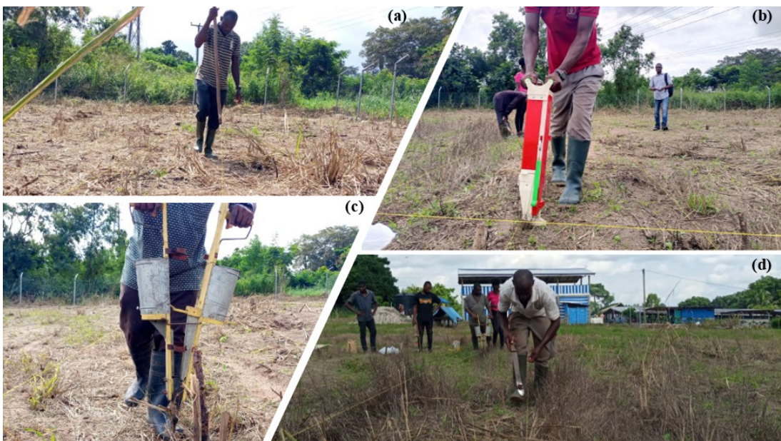
Fig. 1: The seed sowing tools (a) dibbler pole (b) auto seeder (c) jab planter (d) cutlass
