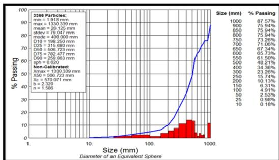
Fig. 12 Analysed Blast Muckpile
