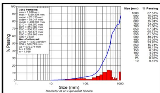
Fig. 12 Analysed Blast Muckpile
