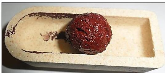
Fig. 1 Iron Oxide-Epoxy Composite Pellet
