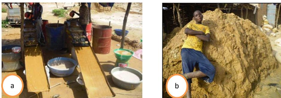
**Figure 2** : Procédé d'extraction d'or par séparation gravitaire (a) et rejet du sable de lavage après extraction d'or (b).
