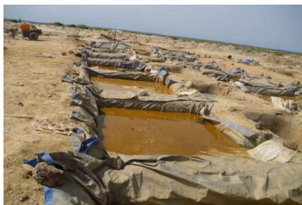
**Figure 3** : Bassins de cyanuration utilisés dans la zone de Komabangou.
