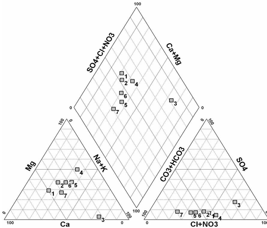
Figure 4 : Classification des eaux à partir du diagramme de Piper.
