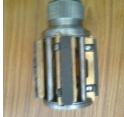
Figure 1 (d) Rotary honing tool
