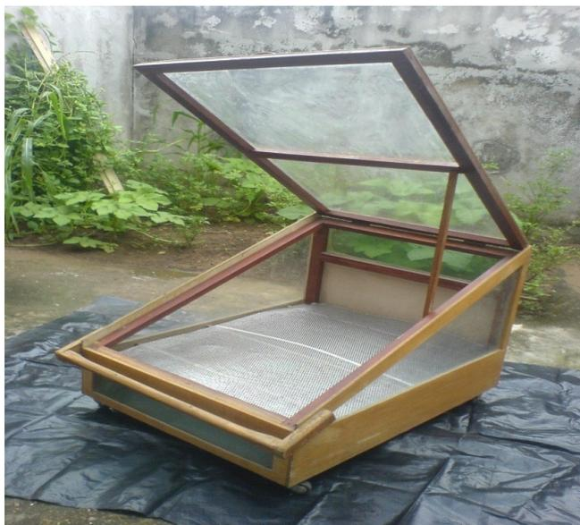
**Photographie 1:** Séchoir solaire cadre type NRI utilisé pour le séchage de la pulpe de banane plantain
