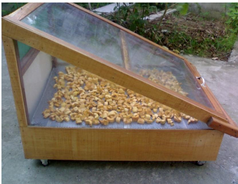
**Photographie 2:** Séchage de la pulpe de banane plantain bien mûre à l'aide du séchoir solaire cadre type NRI.
