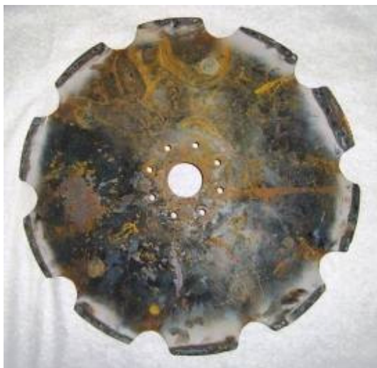
Figure 5: Vue générale du disque UD 7.5.00 en acier 65G renforcé par décharge électrique, avec un affûtage simultané (angle d'affûtage 30°)
