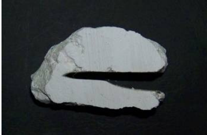
Figure 8 : Vue générale du profil de la lame du disque consolidé par décharge électrique (après 60 ha d'exploitation).
