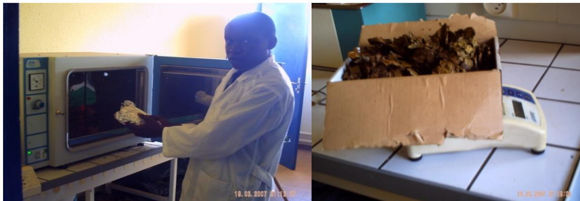
**Figure 4 :** Séchage à l'étuve et pesage des échantillons
