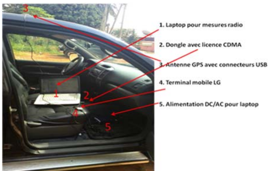
Figure 1 : Kit de mesure et de collecte installé sur un véhicule.
