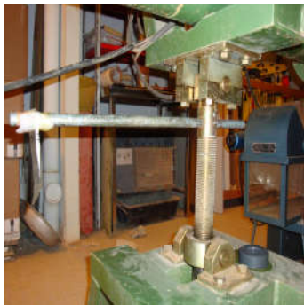
Photo6: système vis-écrou utilisé
