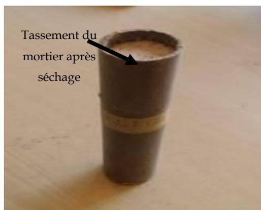
**Fig. 8.** Exemple du tassement du mortier SM après durcissement
