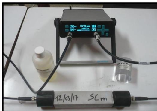
Fig. 12. Mesure de la vitesse ultra-sonique
