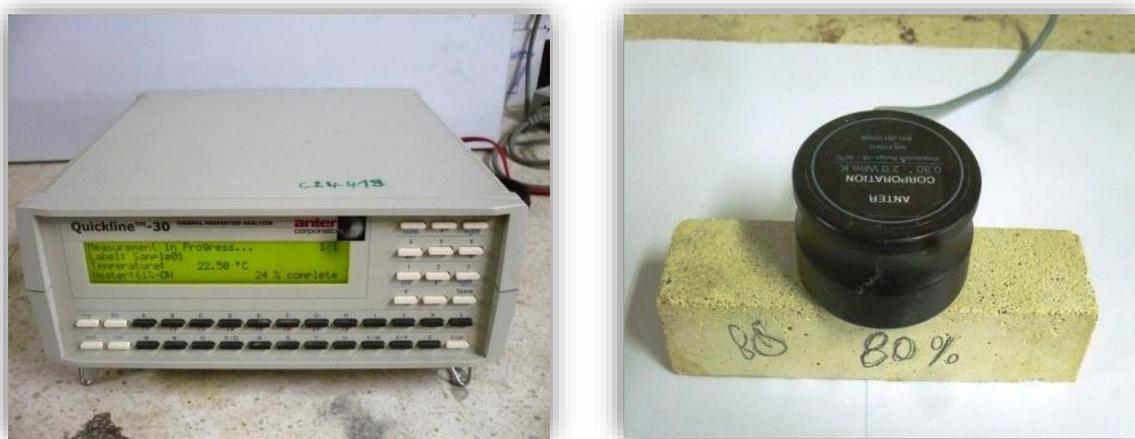
**Fig. 16.** Conductivimètre et sa sonde de surface
