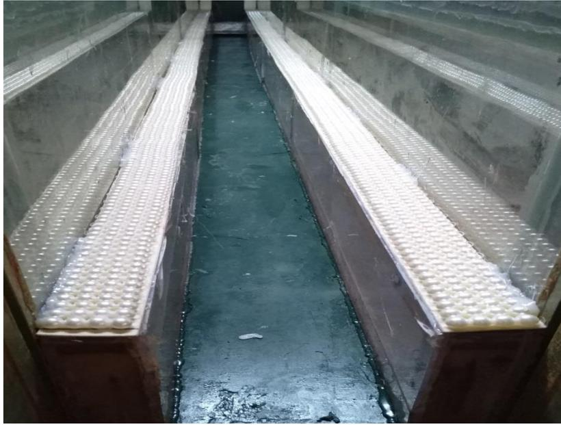
**Photographie .3.** Photographie d'un tapis rugueux soigneusement collé sur le lit majeur du canal rectangulaire de section composée
