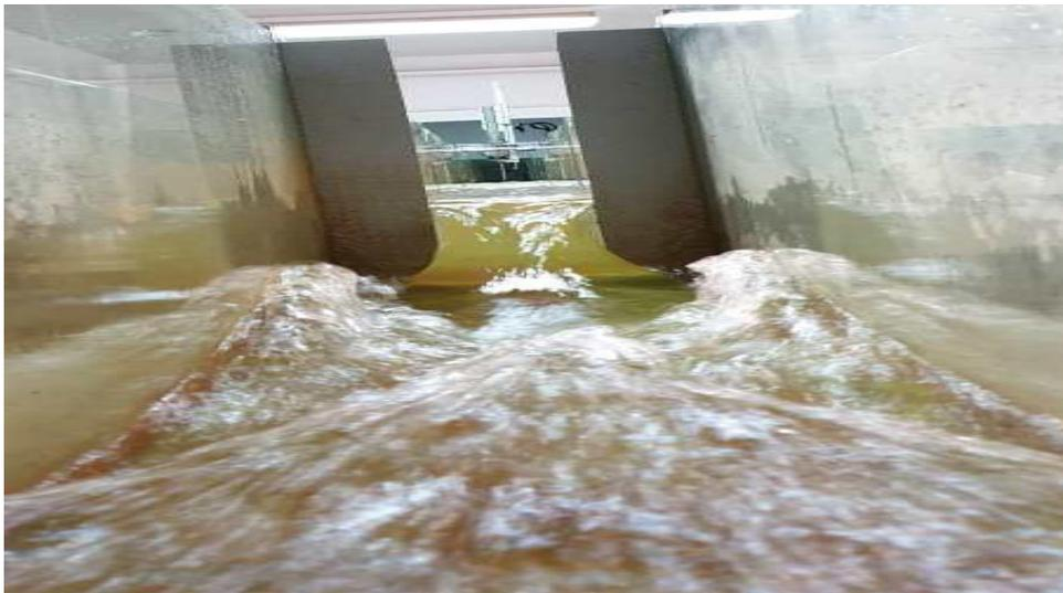
**Photographie .2.** Déversoir rectangulaire utilisé aux mesures des lames déversantes
