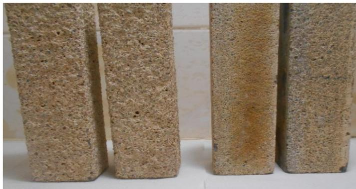
**Fig.5.** Aspect des éprouvettes après une conservation des 12 semaines dans une solution d'acide sulfurique.
