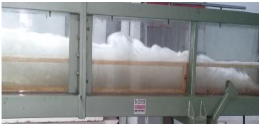
**Photographie 1.** Photographie du canal d'expérience rectangulaire de section composée à fon rugueux
