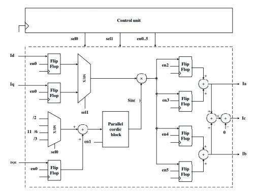
Fig.5. Block diagram of the DQ-ABC module
