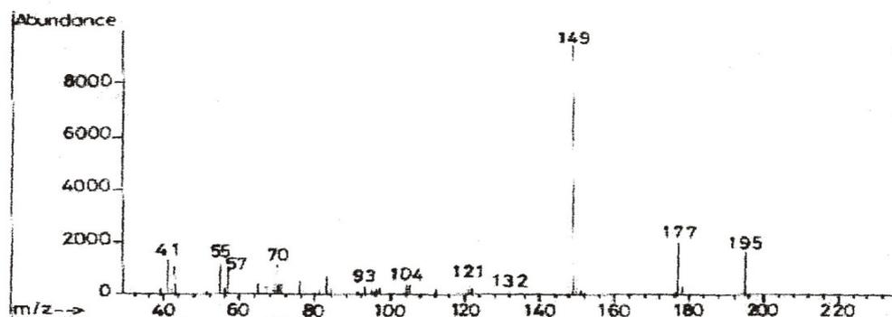
Figure 1 Mass spectrum of bis (2-methoxy ethyl) phthalate
