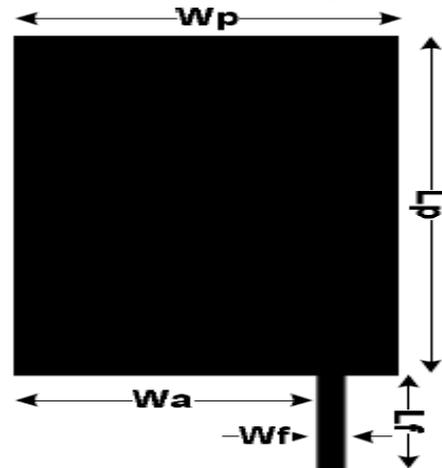
Figure 1: Edge Fed Microstrip Patch Antenna
