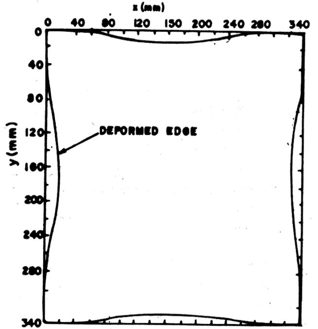
Fig. 7. Edge Pull - in blank of Fig. 6.
