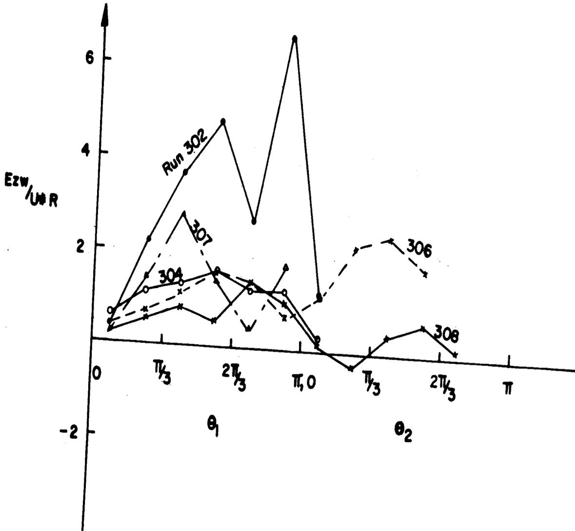
FIGURE 6. LONGITUDINAL VARIATION OF THE NORMALISED TRANSVERSE MIXING COEFFICIENT.
