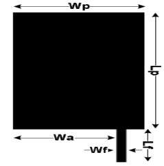
Figure 1: Edge Fed Microstrip Patch Antenna
