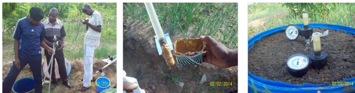
Figure 2. Installation des tensiomètres
