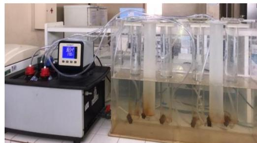
**Figure 1.** Dispositif expérimental du test de BMP
