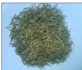
Figure 4. Fibres de diss après concassage et découpage
