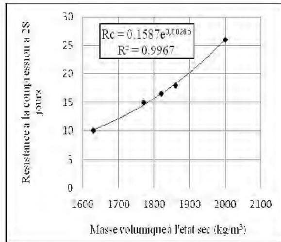
Figure 6. Evolution de la résistance à la compression à 28 jours en fonction de la masse volumique sèche.
