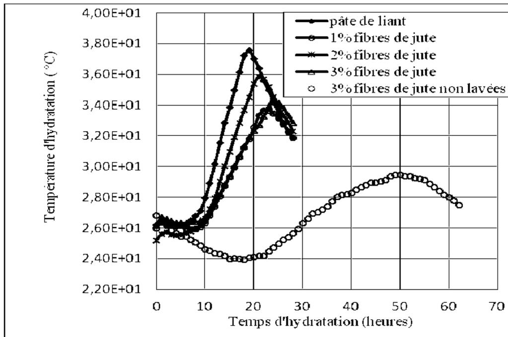
Figure 3. Température d'hydratation des mélanges (liant+fibrés) en fonction du temps.
