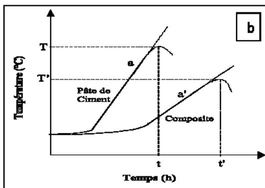
Figure 2b. Exemple type de courbe température - temps lors de l'hydratation
