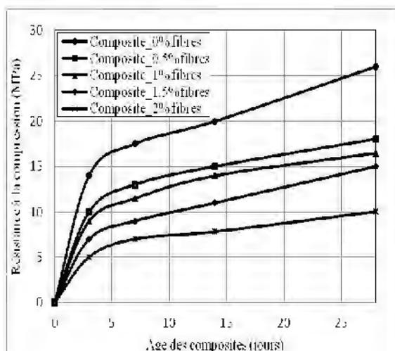
Figure 5. Evolution de la résistance à la compression En fonction de l'âge des composites.
