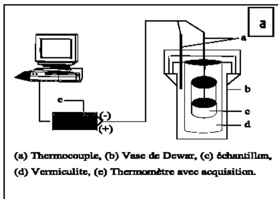
Figure 2a. Dispositif expérimental du test d'hydratation.
