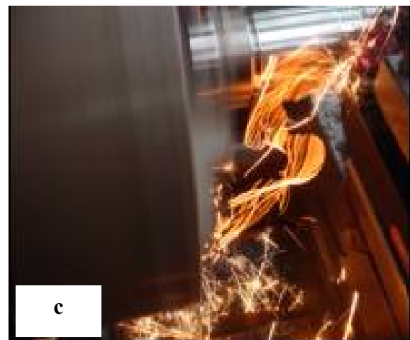
Figure 8: Évacuation de la chaleur par le copeau à différentes phases (220 m/min).
