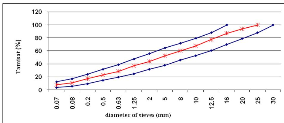
Figure 3.a. Grading curve of the 1<sup>st</sup> mixture « Filler 10 % »
