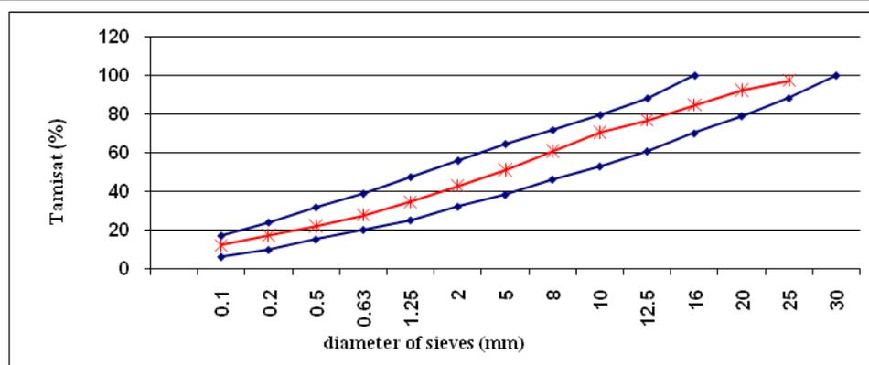
Figure 3.b. Grading curve of the 2<sup>nd</sup> mixture « Filler 15 % »
