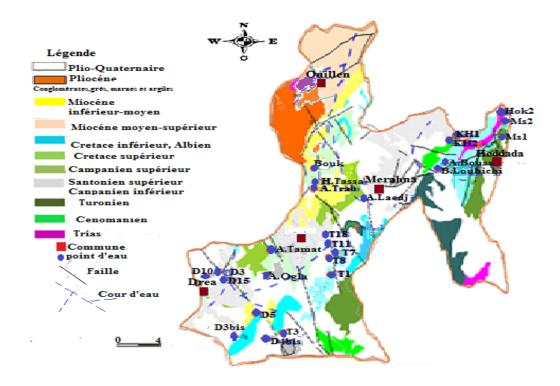
Figure 16. Carte géologique et la position des points de ressource en eau de la nappe de Taoura.
