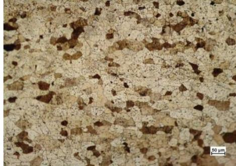
Figure 2. Microstructure optique montrant la structure de l'acier inoxydable de type 410S.
