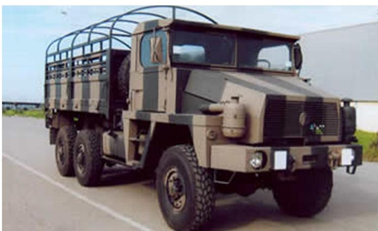
Figure 1 : Camion SNVI M 230 (6 cylindres de 230 chevaux).
