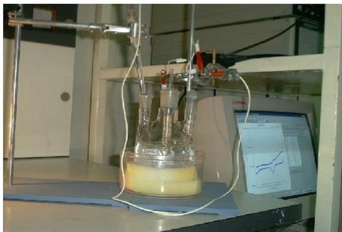
Figure 2 : Photographie de la cellule Pt/0,5 MH<sub>2</sub>SO<sub>4</sub> (fabriquée par Verre-Lab Constantine) plongée dans un bain thermostaté. (L'électrolyte est une solution de 0,5 M H<sub>2</sub>SO<sub>4</sub> préparée à partir d'un acide très concentré de H<sub>2</sub>SO<sub>4</sub> (98,98%) et d'eau distillée).
