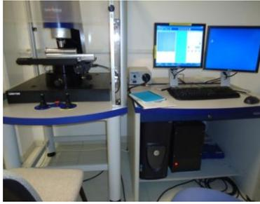
Figure 4. Rugosimètre Taylor Hobson, Taly surf CCI
