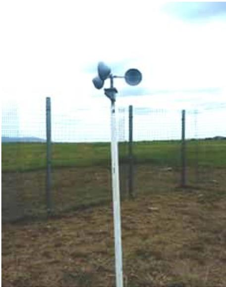
Figure 1: Cup-Anemometer
