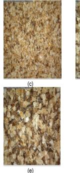
Figure 1: Microstructure images of DSP (x75 magnification): Key: (a) 100 µm (b) 200 µm (c) 300 µm (d) 400 µm (e) 500 µm, respectively
