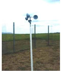
Figure 1: Cup-Anemometer
