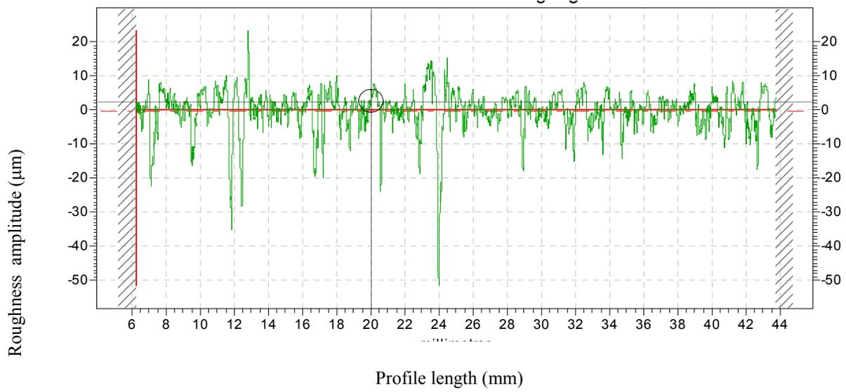
*Fig. 2 (d) - Roughness amplitude against profile length for 4<sup>th</sup> removal*
