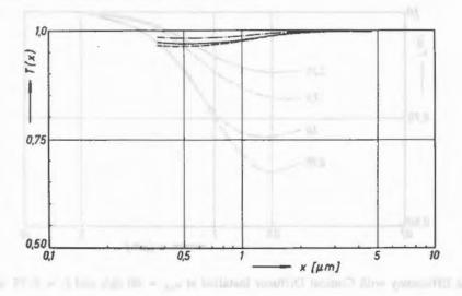
Figure 8 Dependence of the Grade Efficiency on the Diffusor Geometry,  $u_{LK} = 110 \text{ m/s}$ ,  $L = 1.5 \text{ x } 10^{-3}$ ; Inv. Parabolic (--), Conical (---)and Parabolic(--)
